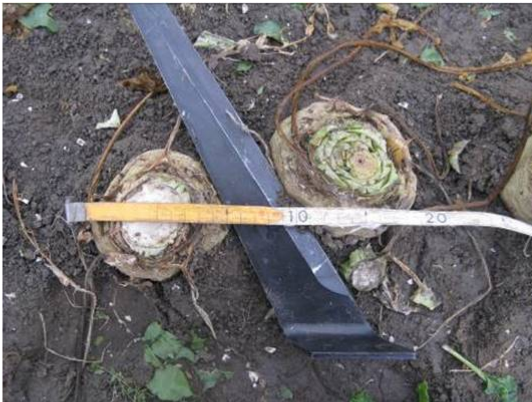
Figuur 8.3.3 Bij een te kleine afstand tussen de bieten is er onvoldoende ruimte en tijd voor het kopmes om goed kopwerk te leveren. De oorzaak ligt vaak in krappere zaaien dan 17 cm in de rij of zoals op de foto: een onregelmatig bestand door versleten zaaischijven.
