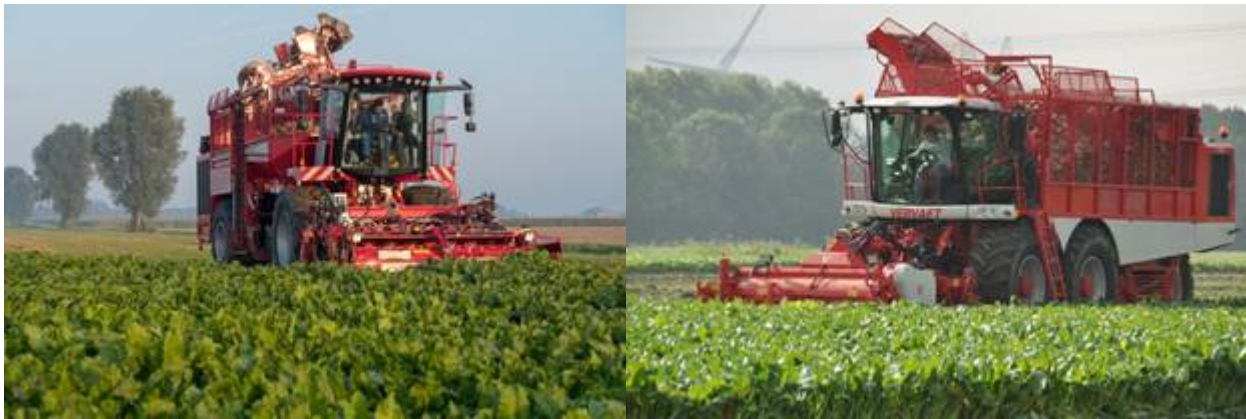
Figuur 8.2.1 Een zesrijige bunkerrooier ontbladert, kopt, licht, reinigt, verzamelt en transporteert de bieten in één werkgang.
