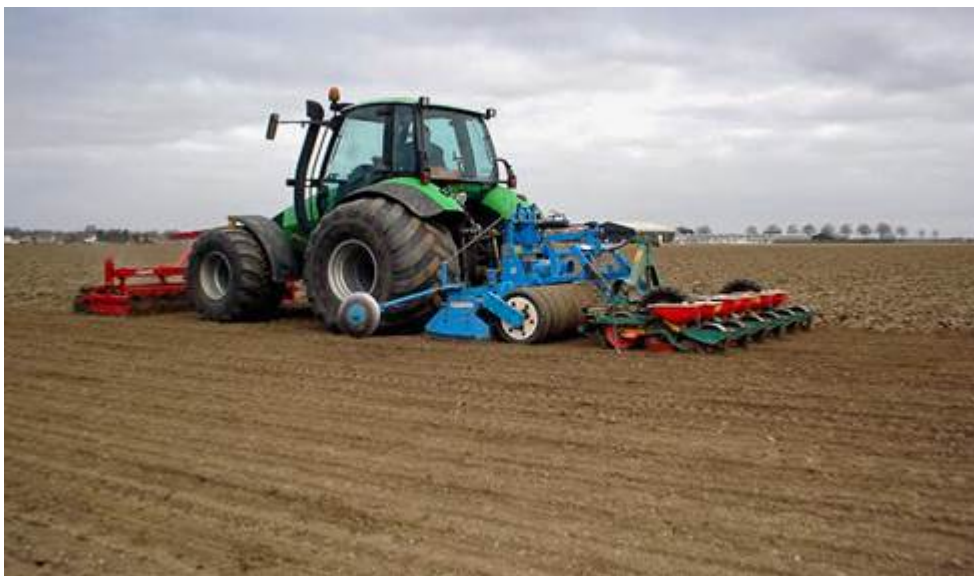
Figuur 2.2.7 Ideaal: gunstige omstandigheden, zaai bed maken en zaaien in één werkgang en rijden met een lage bandendruk.
