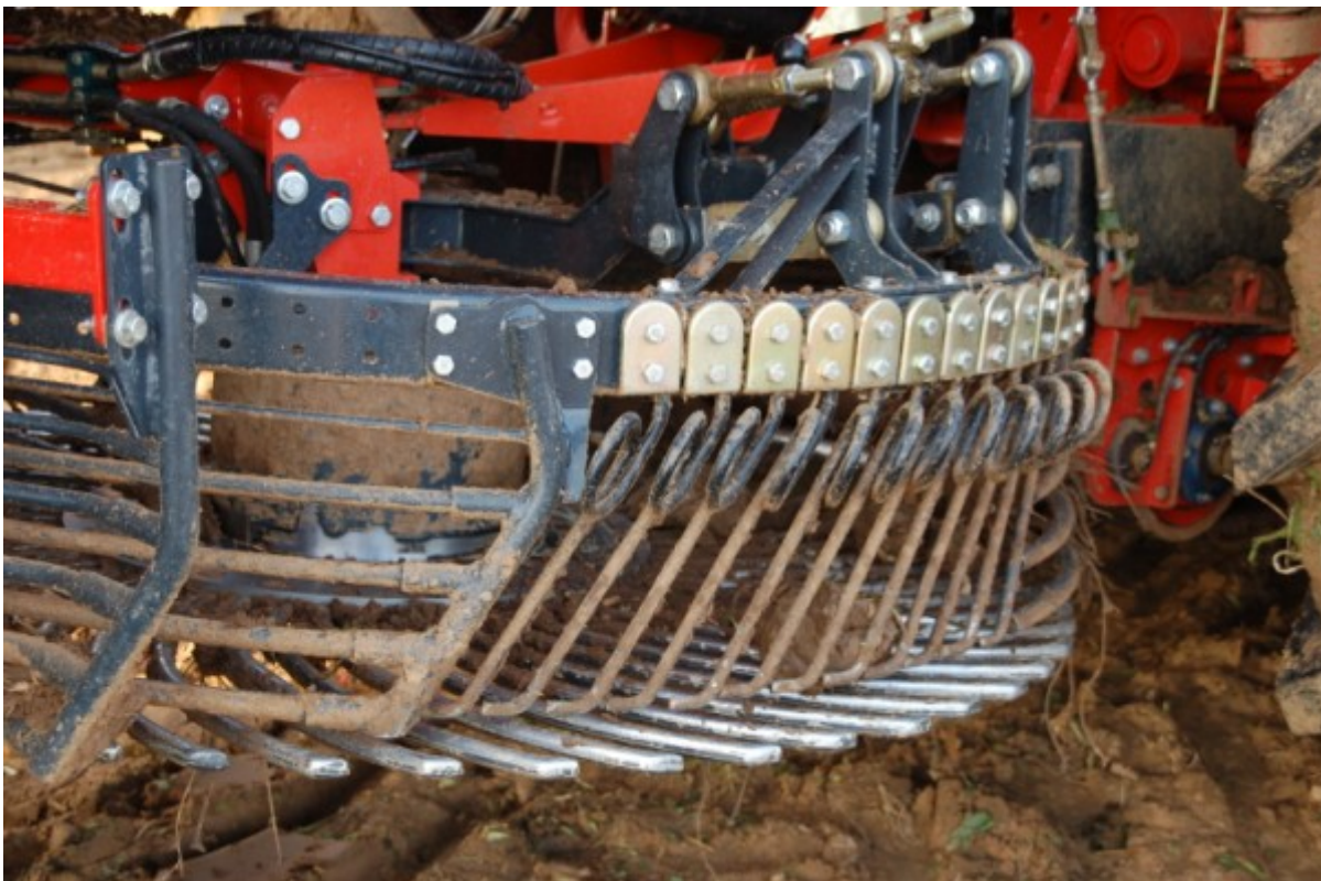
Figuur 8.2.6 Bij zeefraderen geeft de uitvoering met open zeefraderen en verticale veertanden de meest effectieve reiniging.
