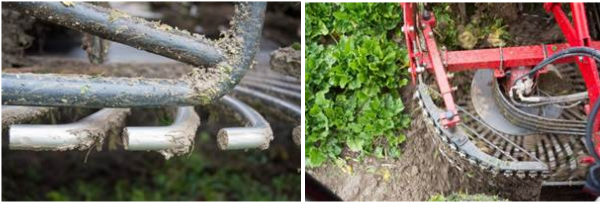
Figuur 8.2.5 Open rooizonnen (zonder ring aan de omtrek) voor beter lossen van losse grond en bladpruiken. Dit voorkomt op zware kleipercelen dat de reiniging agressief moet werken om deze grond alsnog te verwijderen.
