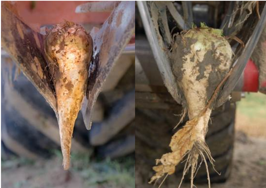
Figuur 8.2.3 Zowel rooischaren (links) als aangedreven rooiwielen (rechts) lichten de bieten over het algemeen met de punten er nog aan.
