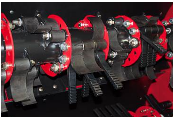
Figuur 8.2.2 Ontbladersysteem zonder kopmessen. De stalen klepels verwijderen het blad tussen de rijen. Kortere stalen klepels en wat langere rubberen klepels verwijderen blad in de rij en de bladresten van de bieten.
