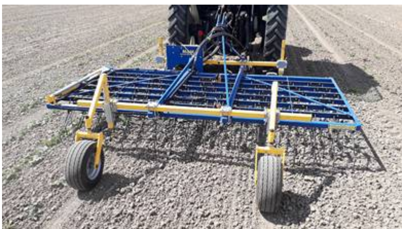
Figuur 6.2.2 Wiedeg, druk op tanden hydraulisch geregeld vanaf de trekker.
