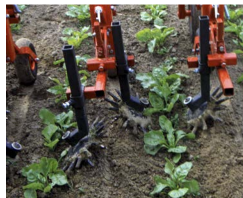
Figuur 26 Vingerwieders kunnen worden gebruikt voor onkruidbestrijding in de rij.
