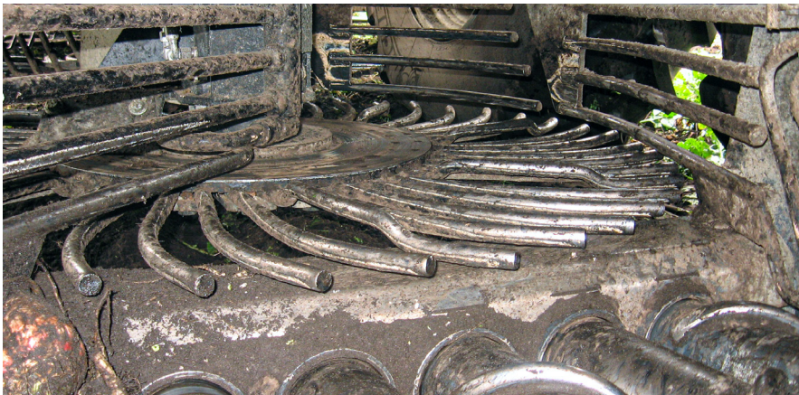
Open rooizonnen en axiaalrollen maken voldoende reiniging ook op zwaardere grondsoorten mogelijk, echter door te intensieve afstelling kan onnodige puntbreuk ontstaan.
