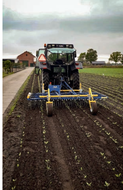
Een wiedeg kan vanaf het vierbladstadium van de bieten ingezet worden
