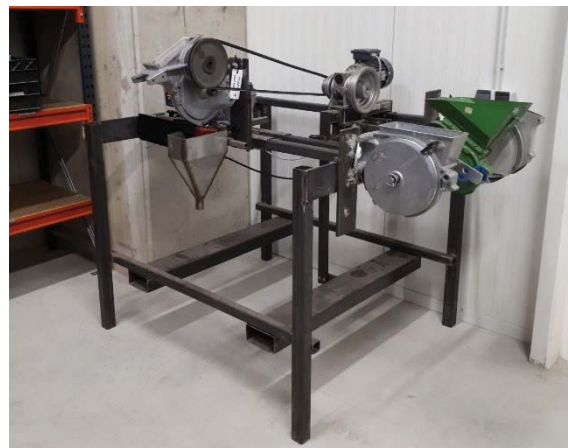
Figuur 2. De nieuwe verzaaibaarheidsopstelling. Met deze opstelling kunnen partijen zaai-zaad met de elementen en bijbehorende zaaischijven van de meest voorkomende typen zaaimachines worden getest.
