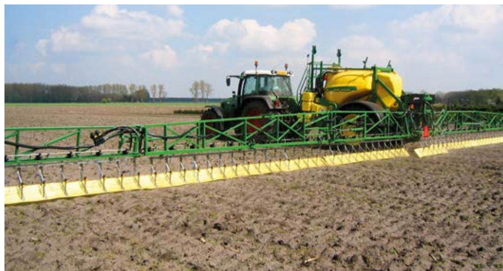
Met een Släpduksysteem is het mogelijk om met een relatief fijne spuitdruppel minimaal 75% driftreductie te realiseren.
