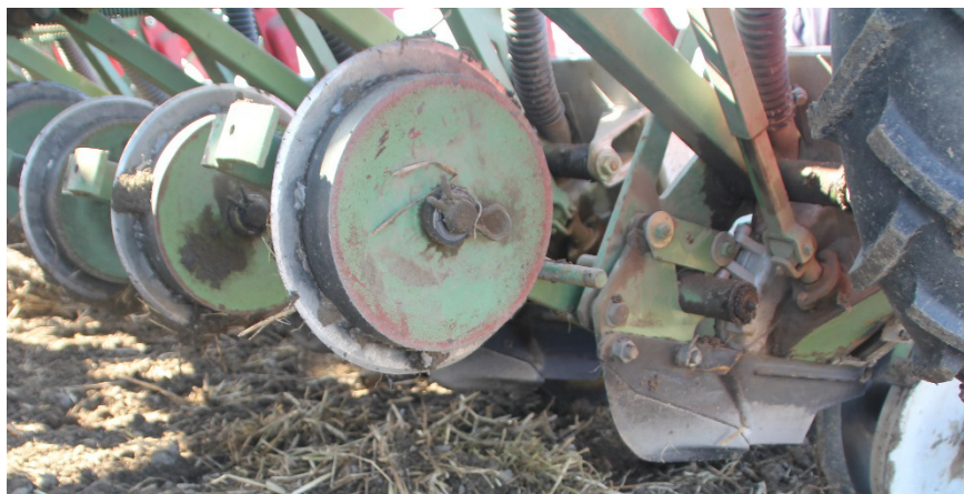
Foto 1. Snij schijf gemonteerd op front loopwiel bietenzaaimachine.
