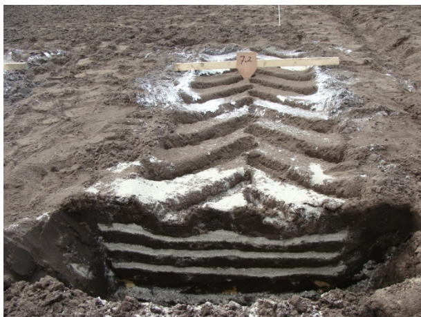
Bandenspanning op 0,8 bar geeft een insporing van 7,2 cm (bandenspanning volgens tabel).
