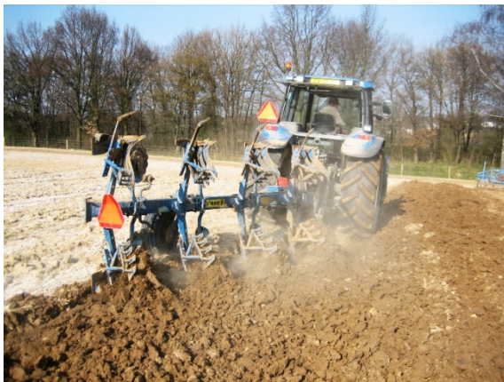
Ondiep ploegen (stoppelploegen), waarbij de grond tot een diepte van 12 cm wordt gekeerd en daaronder wordt gebroken door verlengde ondergronders.
