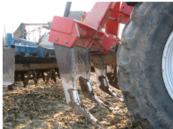
Voorzetwoeler voorzien van zes tanden op drie meter werkbreedte voorzien van smalle beitels (60 mm).
