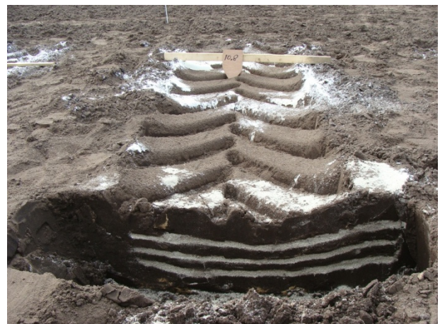
Bandenspanning op 2,5 bar geeft een insporing van 10,8 cm (bandenspanning in de praktijk bij deze trekker).
